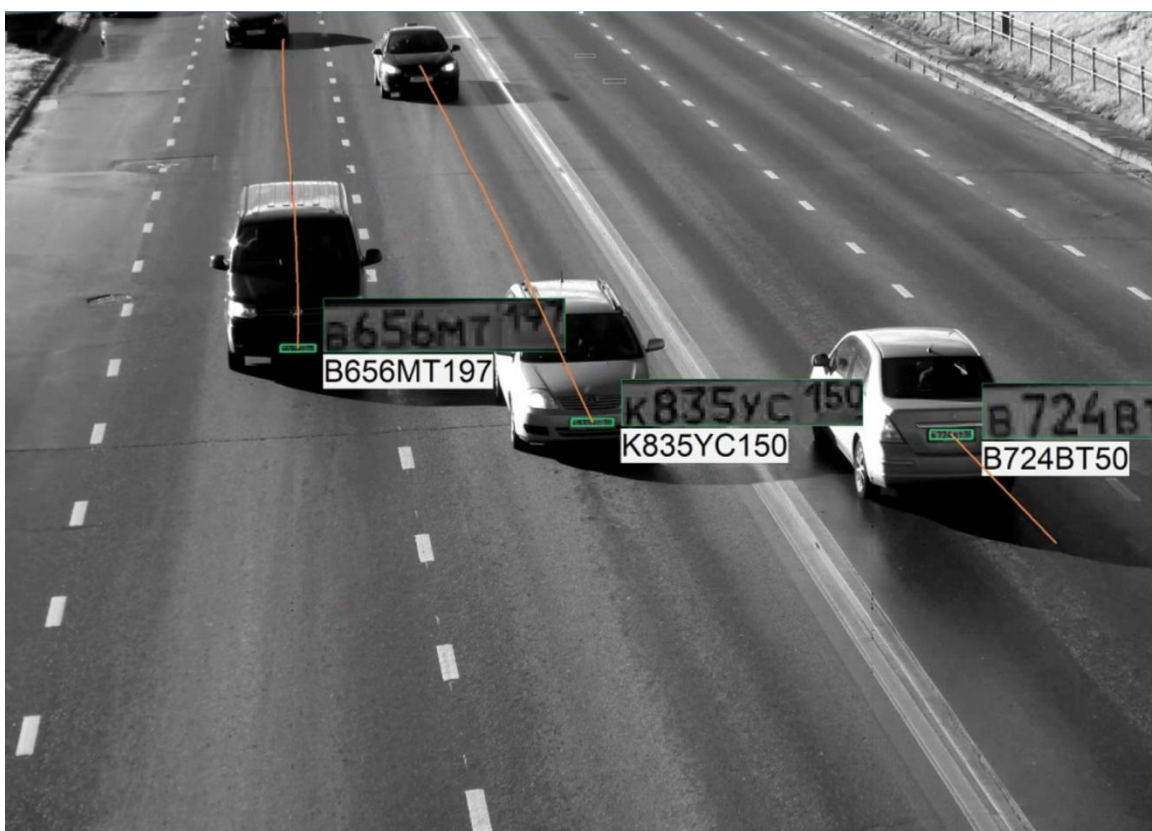
Рисунок 1. Пример работы алгоритма отслеживания автомобилей
